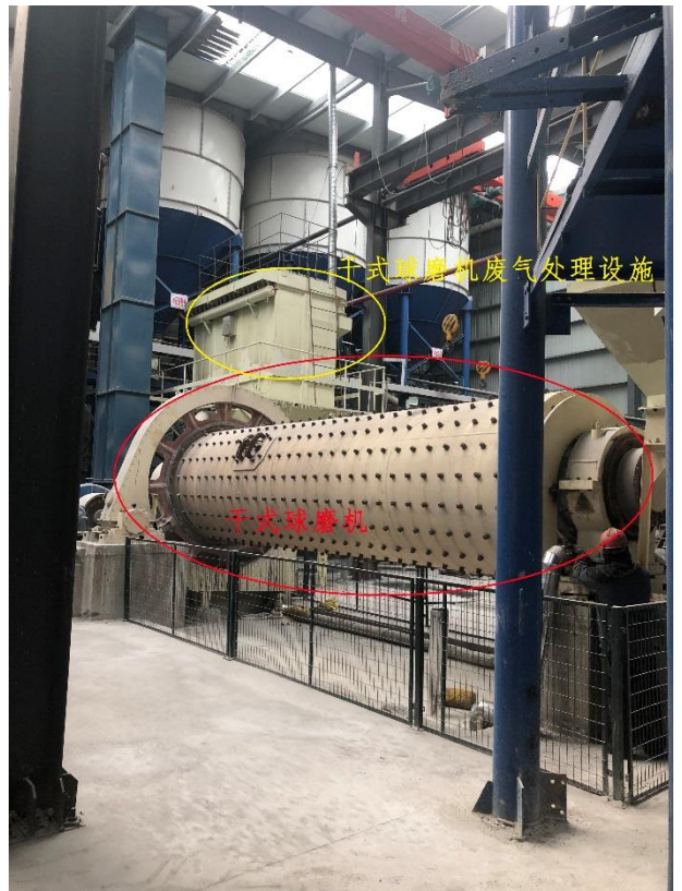
加气混凝土砌块干式球磨机
